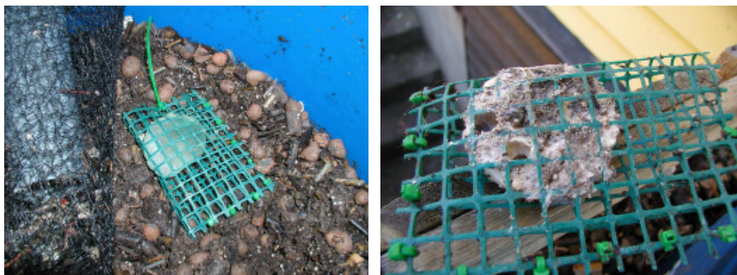
Figur 5. I nedbrytningsförsöket testades olika fett och vegetabiliska oljor. Här syns olivolja i gelatin vid försöksstart samt efter tre veckor.
