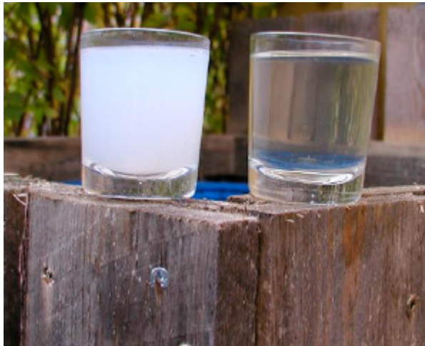
Figur 6. Vattenkvalitet före och efter mullfilter vid provtagning med konstgjord diskvattenblandning.
